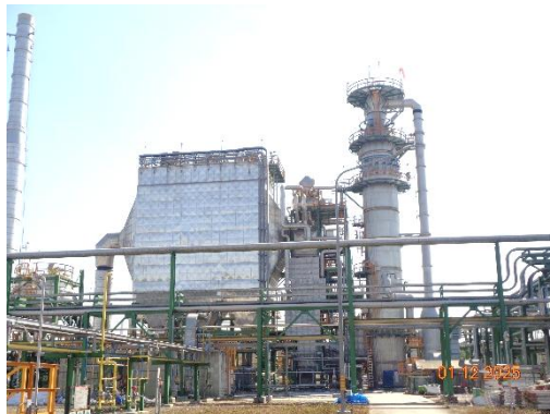
รูปที่ 3.21 Dust Removal Unit
